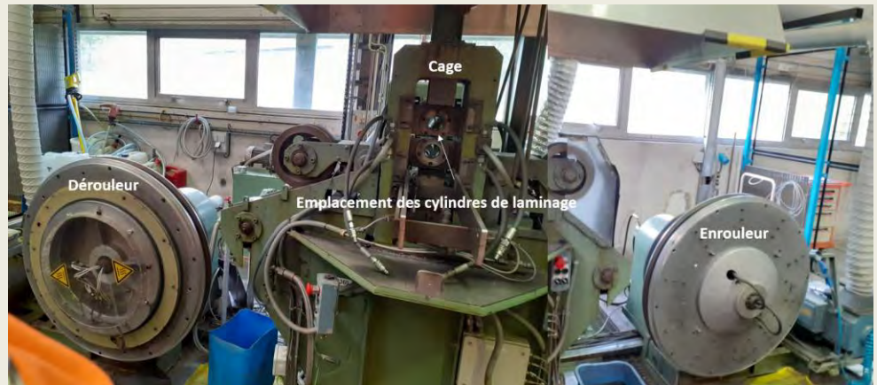
Figure 3 : le laminage-pilote de Constellium C-TEC (Voreppe)
