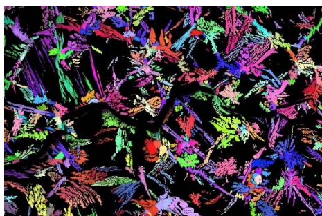
« Kimono gamma » Acier ER312 fragilisé par H2
