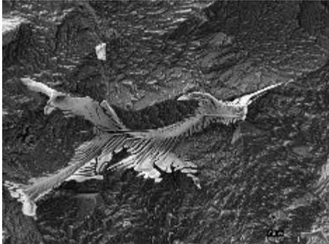
Il s'agit d'une micrographie MEB (x1000 – 8kV – SE) d'un alliage 5xxx utilisé pour la décoration dans le bâtiment, après dissolution partielle de la matrice d'aluminium.
