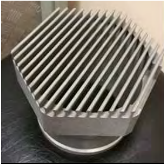
Exemple de grille d'assemblage répondant au design préliminaire du projet de réacteur de 4 ème génération ASTRID obtenue via les procédés de fabrication additive
