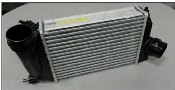
Figure 1 : Refroidisseur d'air de suralimentation air-air pour une configuration de type boîte avec un faisceau brasé (avec des boîtes d'extrémité en plastique renforcé de fibres de verre et des joints élastomères).
